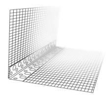
Perfil cantonera de PVC con malla de fibra de vidrio álcali-resistente y certificada ETAG 004, válida para cualquier espesor de mortero, protege los ángulos horizontales y verticales en aristas, ventanas y puertas, ayudando a la formación de cantos perfectos, tanto alineados como perpendiculares.
